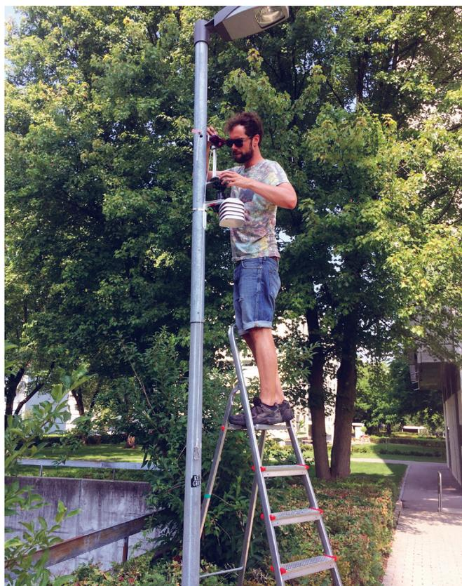
Der Klimatologe Moritz Gubler montiert einen der kostengünstigen Temperatursensoren mit selbstgebautem Strahlungsschutz an einem Standort des Berner Stadtklima-Messnetzes. Foto: Lukas Meyer.
