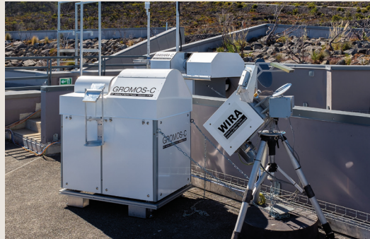
The WIRA wind radiometer in operation at the Observatoire du Maïdo on La Réunion island.
